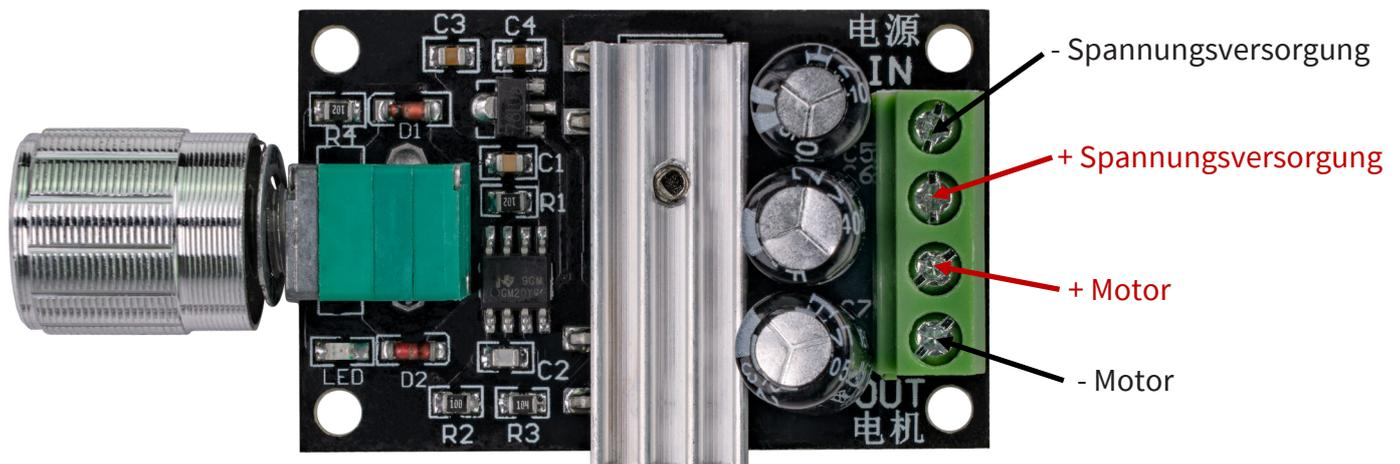
Durch das Drehen des Potentiometers wird die Geschwindigkeit des Motors mittels PWM eingestellt.
